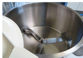
Mischerinnenraum Uni tec® und Detailansicht des Sprühsystems
