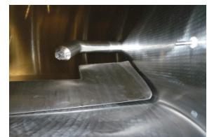
Mischerinnenraum Uni tec® und Detailansicht des Sprühsystems
