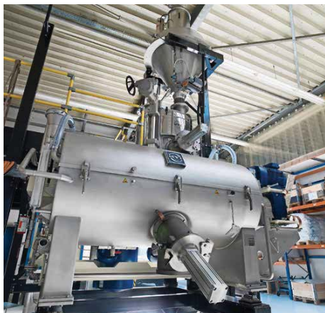
Flexibilität in Edelstahl: Das R&D-Center in Detmold verfügt über eine Heiz-Kühl-Mischer-Kombination mit variablen Messerköpfen, Siemens Profisafe-Steuerung, Wägezellen zur Ermittlung des Chargengewichts während des Betriebs, fernüberwachte Lagerstellen sowie Sackaufgabestation und Vorbehälter für hohe Durchsatzleistungen. Foto: MTI
