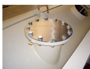
Zusätzlicher Ein- laufstutzen auf dem Kühlmischer
